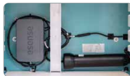
Kit batterie non visible situé dans le « vide sanitaire » du chariot pour optimiser l'espace et protéger le kit des chocs extérieurs.
